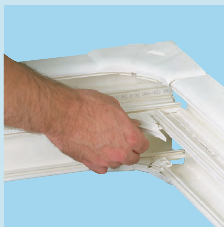
Na canaleta de dois ou mais compartimentos é necessário colocar um separador para cotovelo interno, garantindo a separação contínua dos compartimentos e a fixação da tampa.
