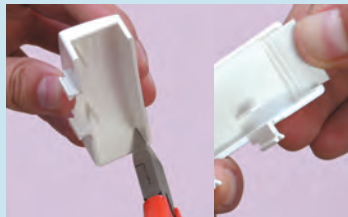
Remover o pré-corte do acoplador
