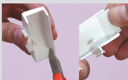
Remover o pré-corte do acoplador
