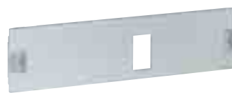
208 13 Espelho frontal metálico 1/4 de volta para DPX 3 160, montagem horizontal fixado em placa ajustável Altura 150 mm
