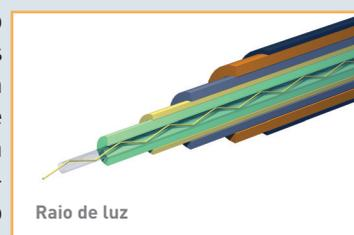
O revestimento de proteção, normalmente uma camada de plástico com espessura entre 25 e 1000 microns, fornece as excelentes propriedades mecânicas da fibra.
