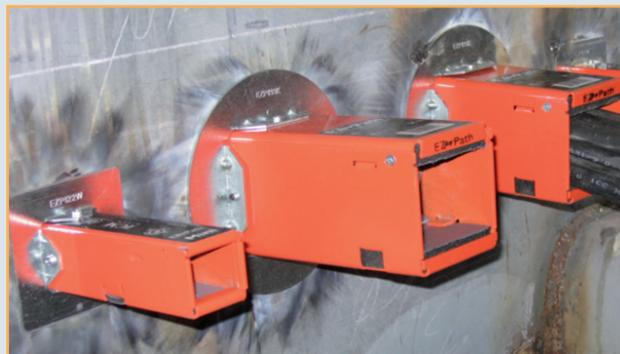
Partições metálicas na parede de teste WFRCC
