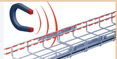
Conecte as eletrocalhas à rede de aterramento (a cada 15-20 metros).
