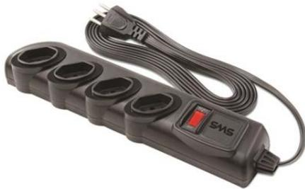
O filtro de linha possui capacidade máxima de 10A/250V, tensão de entrada 115-127 ou 220V, quatro tomadas no padrão brasileiro NBR14136 (2P+T), com dois comprimento de cabos (1,3 e 3 metros), chave disjuntora reset/OFF com função Circuit Breaker e indicação luminosa.
